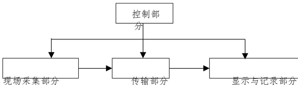
摄像部分：是安装在现场的，它包括摄像机、镜头、防护罩、支架和电动云台。它的任务是对被摄体进行摄像，并把获得的光信号转换成电信号。
